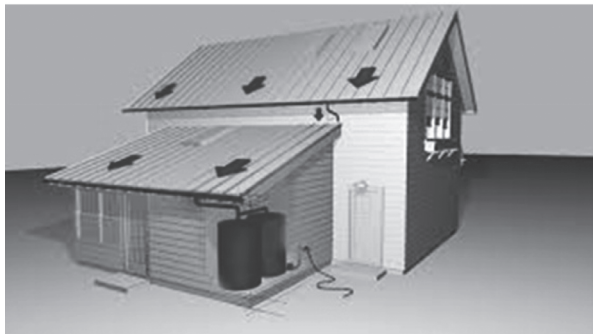
Figura 2. Captación pluvial en tanques de almacenamiento (diseño http://www.greenplanhomes.com/ , reproducido con permiso).
