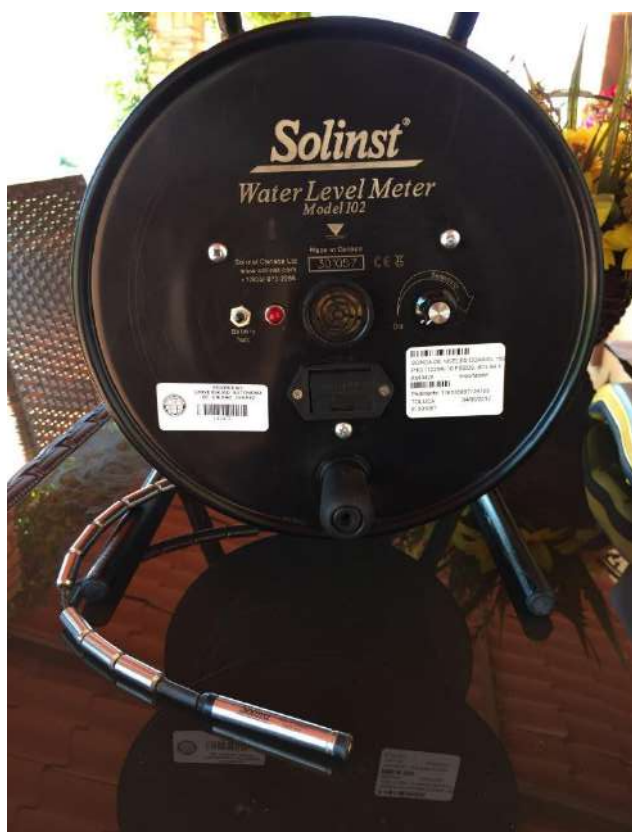
Figura 3. Sonda de arco eléctrico Solinst Model 102.
