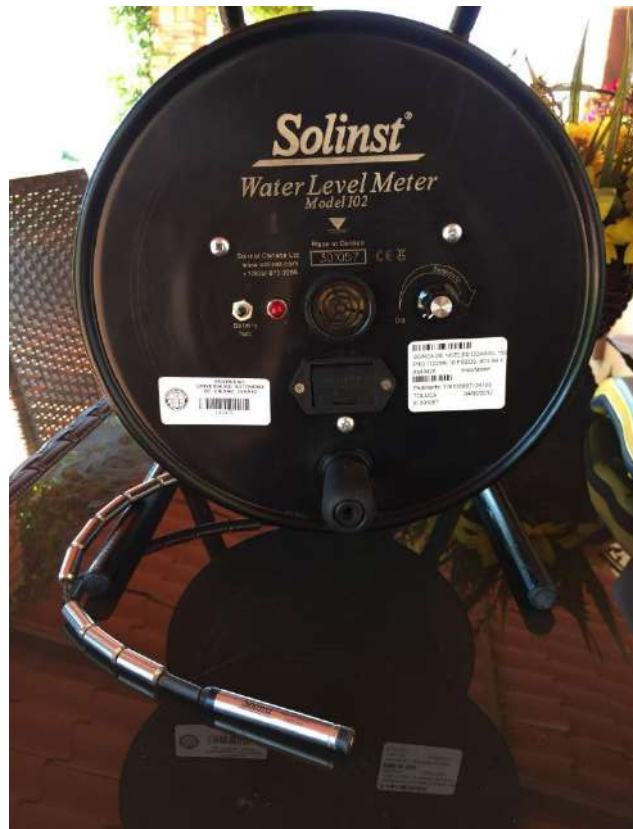
Figura 3. Sonda de arco eléctrico Solinst Model 102.
