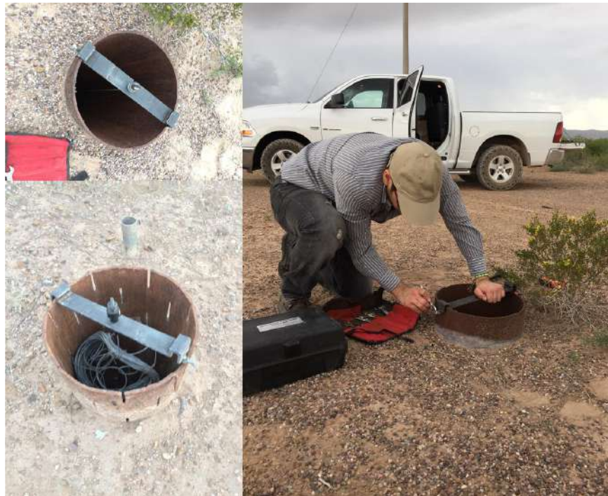
Figura 5. Instalación de piezómetros digitales sobre la infraestructura del pozo (Romero-Gameros, 2018).
