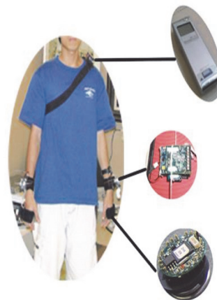
Figura 2. Dos componentes tecnológicos en la computación ubicua a) redes de objetos «inteligentes» y computadoras (WSN) y b) redes del cuerpo humano (WBSN)
