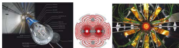
Figura 16. De izquierda a derecha: túnel del LHC , que muestra los haces de protones en direcciones contrarias, confinados, acelerados y dirigidos por 9300 electroimanes superconductores. Al centro se muestra el logo del LHC , que muestra las líneas de campo magnético. A la derecha: experimento ALICE en el LHC , donde se utilizan cuadрупolos magnéticos superconductores .
