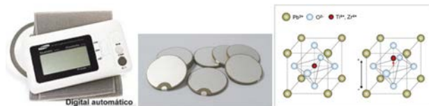
Figura 14. De izquierda a derecha: manómetro digital de tensión arterial, cerámicas PZT comerciales y estructura cristalina tipo perovskita de las PZT, mostrando el desplazamiento relativo de átomo central de titanio o zirconio asociado a una polarización eléctrica.
