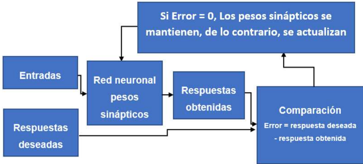
Figura 2. Estructura de entrenamiento de las redes neuronales. Fuente: Esquema elaborado por el autor Figure 2. Training structure of a neural network. Source: Scheme developed by the author
