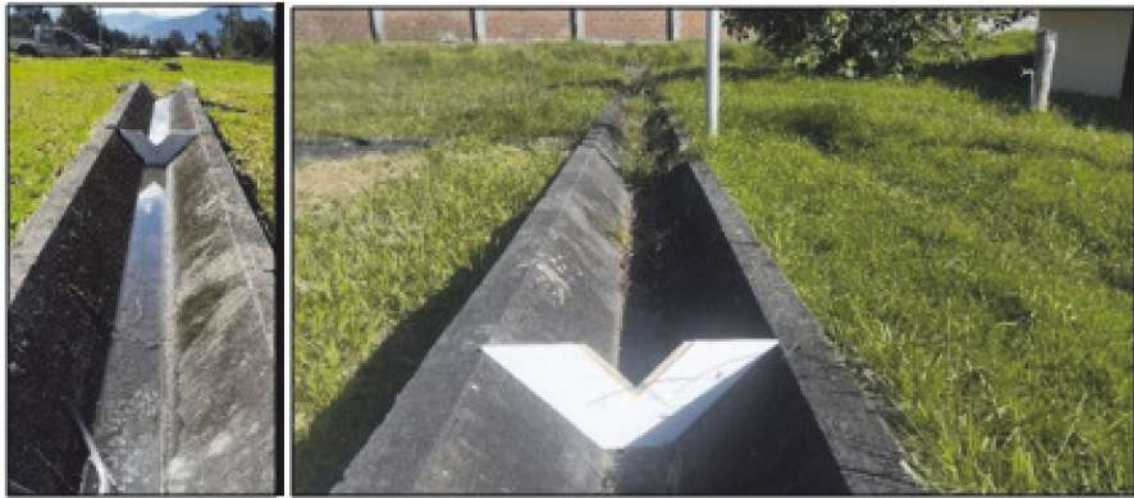
Figura 3. A) Representación de las características del vertedero V-Notch 90^\circ utilizado. B) Imagen con las tres secciones de estudio del canal.
