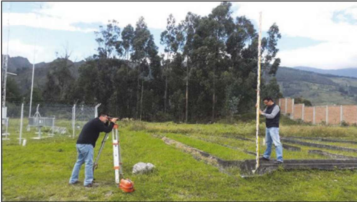
Figura 5.- Trabajo de campo efectuado para medición de la pendiente del prototipo del canal hidráulico.
