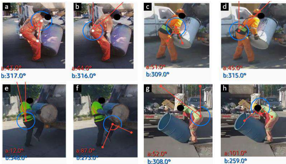
Figura 2. Ejemplo del análisis de ángulos corporales con el software Angulus. a) Extensión de brazo 43°, b) Flexión del tronco 44°, c) Flexión de antebrazo 51°, d) Flexión del tronco 45°, flexión de pierna 87°, f) flexión de tronco 12°, g) flexión de tronco 52°, h) extensión de brazo 101°.
