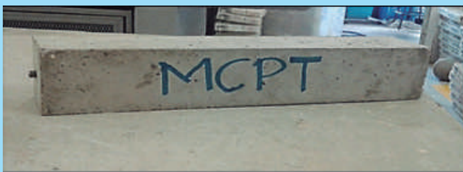
Figura 2. Se muestra barra de prueba del método MCPT 50 x 50 x 285mm.
