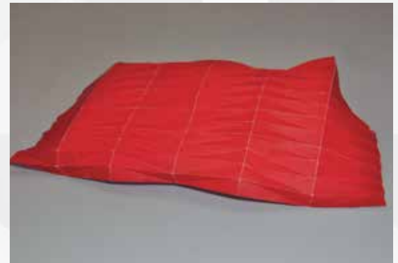
Figura 1. Aquí se aprecia un diseño planamente doblable. Se puede ver el patrón de pliegues, su forma comprimida y su forma extendida.
