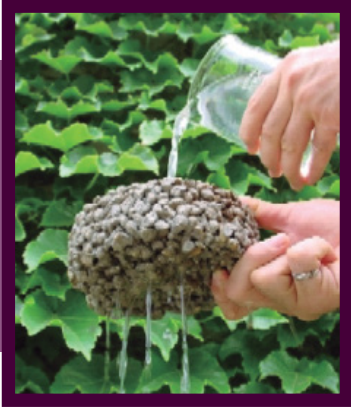
Figura 1. El concreto permeable resulta que se lleva bien con el medio ambiente
