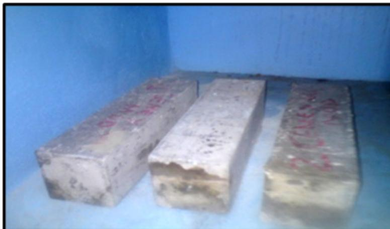
**Figura 2:** Barras de prueba  $75 \times 75 \times 285$  mm.
