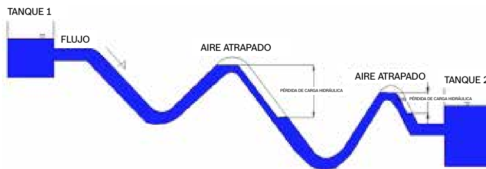
Figura 1. Acumulación de aire típica en un sistema de conducción de agua a gravedad.
