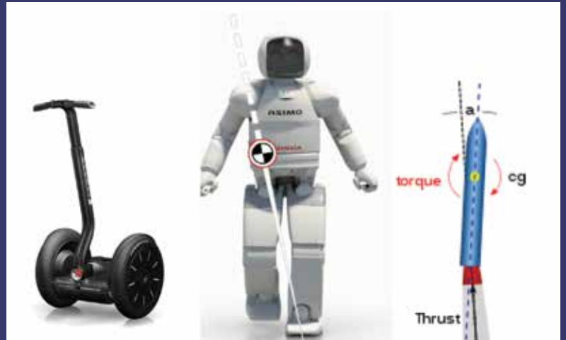
Figura 3. Aplicaciones del péndulo invertido: segway, asimo, control de despegue de un cohete.
