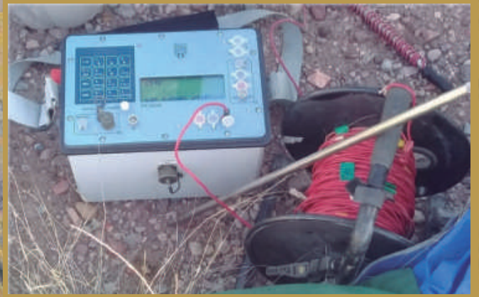
Figura 2. Aparato Syscal Junior Switch 48 IRIS , estacas y cables (Villalobos 2017).
