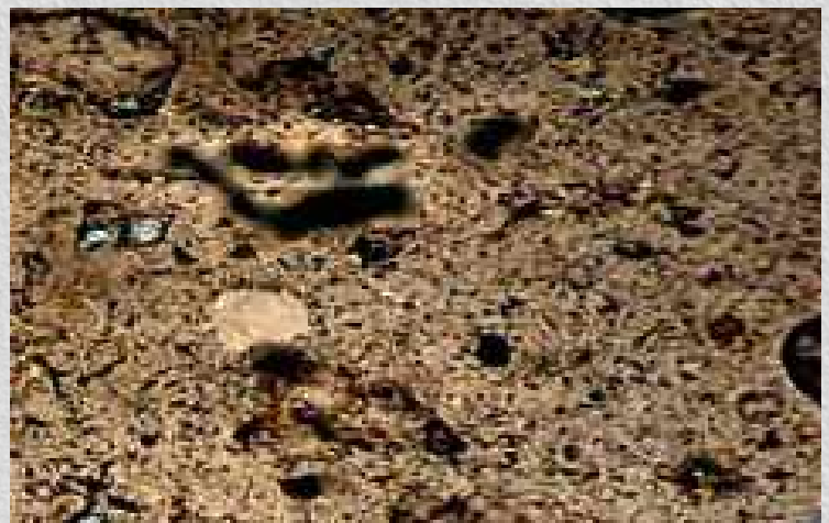
Figura 2. Observación microscópica de agregado ígneo.
