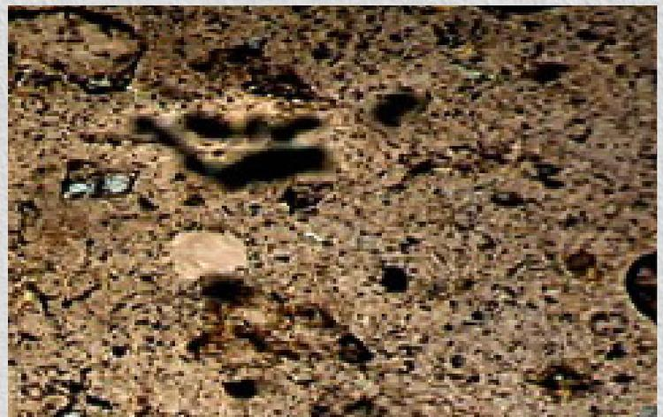
Figura 2. Observación microscópica de agregado ígneo.
