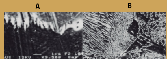
Figura 3. Fotomicrografías MEB, muestran las morfologías de una fase hcp formada durante un tratamiento térmico de homogenizado (a) etapas iniciales (<4 horas); (b) etapas finales (>10 horas) de transformación.
