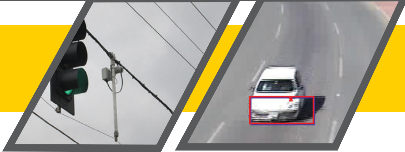
Figura 3. Procesamiento de imágenes de video: a) Cámara instalada en los semáforos; b) Detección de vehículos.
